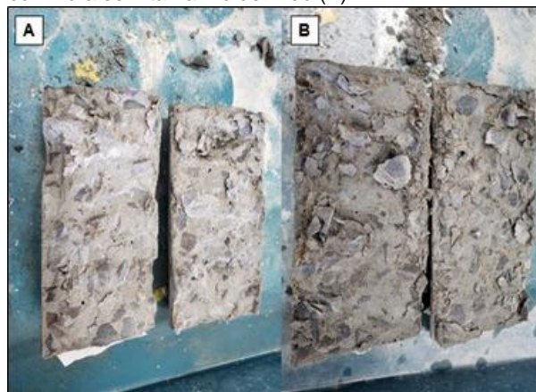
Imagem 5- Rompimento a tração por compressão diametral do concreto de referência (A), e do concreto com fibra sem tamanho definido (B)
